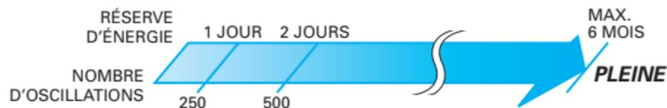
1. Lorsque la montre s'arrête complètement, ou si vous découvrez que la trotteuse se déplace à des intervalles de deux secondes, faites osciller la montre d'un côté à l'autre à une cadence de deux fois par seconde.
